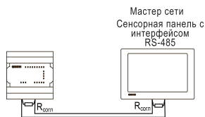
Рисунок 11 – Типовая схема подключения для PR100 в режиме Slave
